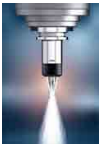
A tenuta per utensili con adduzione refrigerante interna e canali aggiuntivi per portare il refrigerante al livello di taglio negli utensili senza adduzione refrigerante interna
